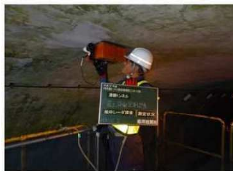
覆工背面空洞探査状況
