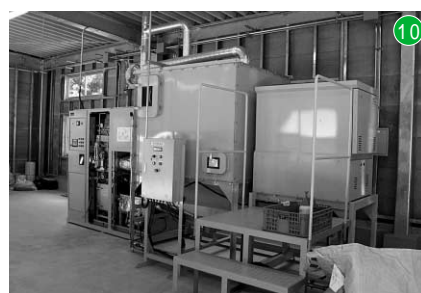
漂着ゴミの3割を占める発泡スチロールを、ボイラーで利用可能な「スチレン油」へ油化し、この装置のエネルギーにも。輸送処分コスト削減と併せ「一石三鳥」。
