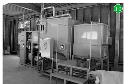
漂着ゴミの3割を占める発泡スチロールを、ボイラーで利用可能な「スチレン油」へ油化し、この装置のエネルギーにも。輸送処分コスト削減と併せ「一石三鳥」。
