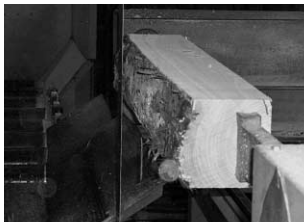
製材所でラミナー加工され端の部分が削られます。製材製品に対する背板の割合は50%です。
