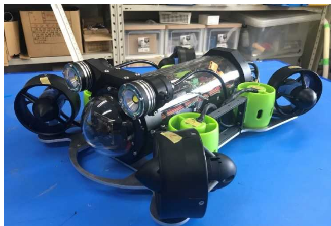
写真 15 社会実装の例。長崎大学による海の次世代モビリティ(ASV:小型無人ボート+ROV:遠隔操作型無人潜水機)実証実験による海上・海中・海底調査システム開発
