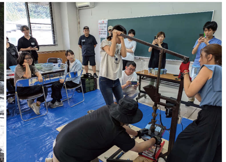
対馬の海岸で回収した海洋ペットボトルキャップを用いた射出成型実証 Demonstration of injection molding using ocean PET bottle caps collected from the coast of Tsushima
